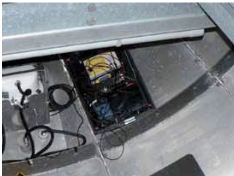
ナセルの底部に設置されたリモートマイク（上）、それに接続されたナセル内の自動バットディテクター（下）。©L. Bach
