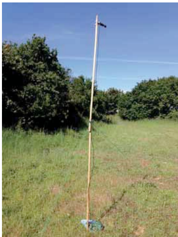
風力タービンの計画された場所に地上 2m にマイクを設置した自動バットディテクター。© J. Sudraud
