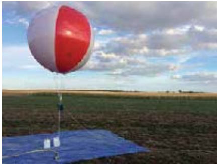
環境影響評価の期間中、コウモリの活動量の調査をするために、気球に自動バットディテクターを取り付けた。© J. Sudraud
