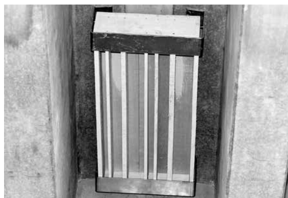
写真2 タイプ1。3通りの幅の隙間を設けた
