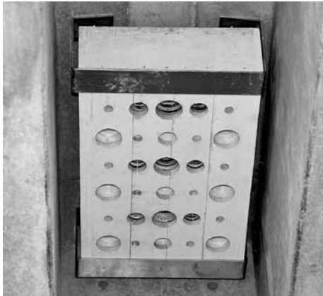
写真3 タイプ2。3通りの直径の丸穴を設けた
